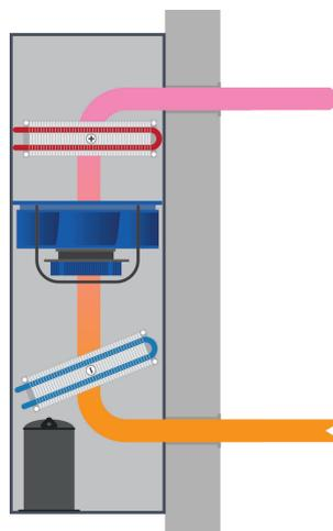
Les modèles CDP 40T, 50T et 70T sont destinés à être installés dans une pièce adjacente et sont munis d'un kit de gainage mural complet avec finition aluminium et grilles de retour d'air (accessoires).
