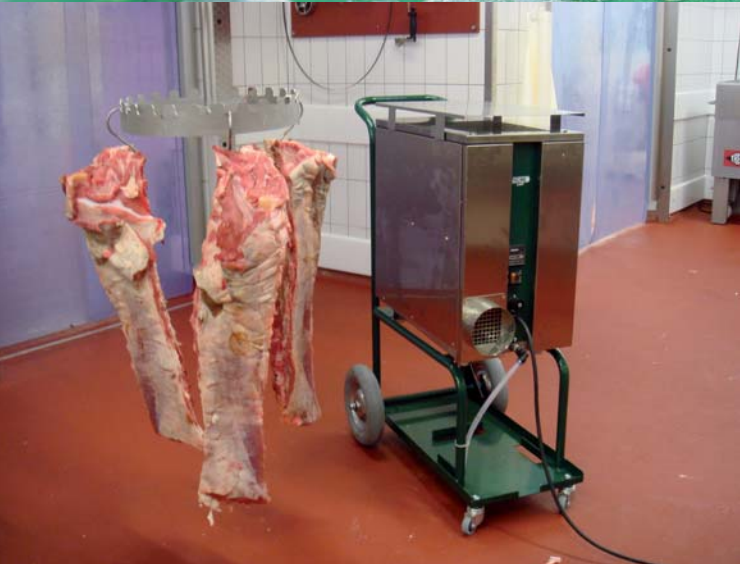
L'Aquasorb A-30Bp, le déshydrateur par adsorption de DST, avec prise pour condensats. L'appareil est monté sur un chariot.
